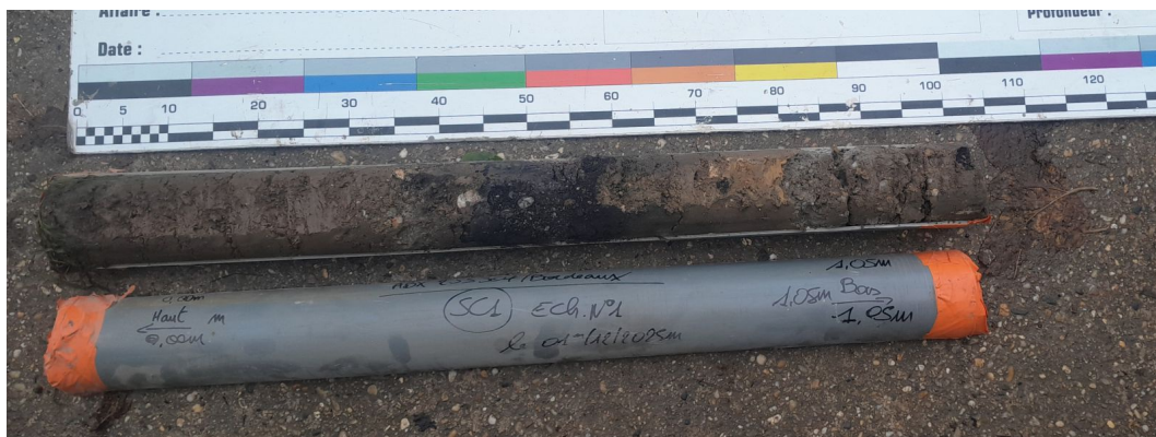
SC1 de 0.00 à 1.05 m
