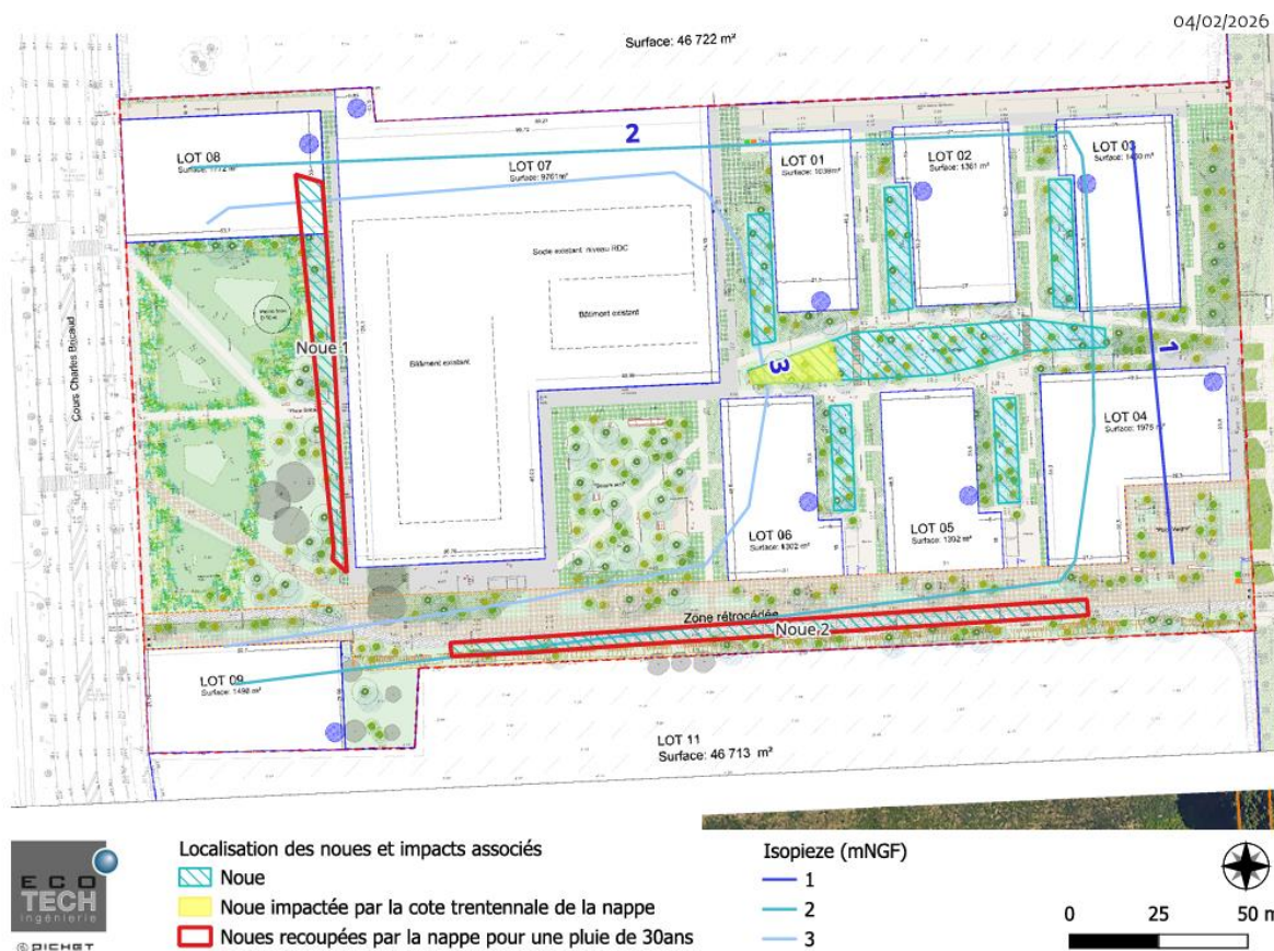
Figure 12: Isopiezies pour une pluie trentennale associée à la projection des systèmes de gestion des EP-noues (Source : Ecotech Ingenierie, 2026)
